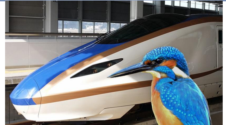
De vorm van de snavel van de ijsvogel vormt nu de aerodynamisch kop van de hogesnelheidstrein in Japan.
